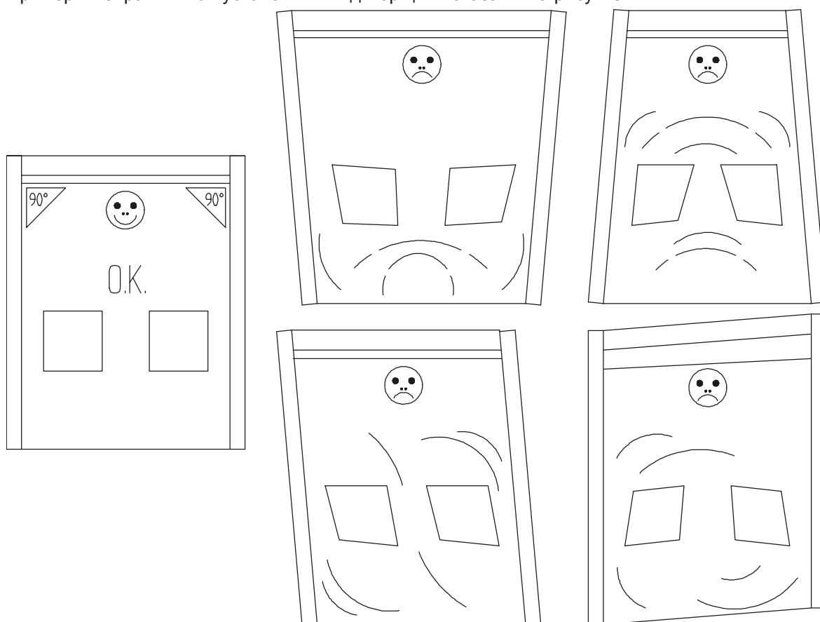
Рисунок 6-7. Установка ворот под правильными углами
