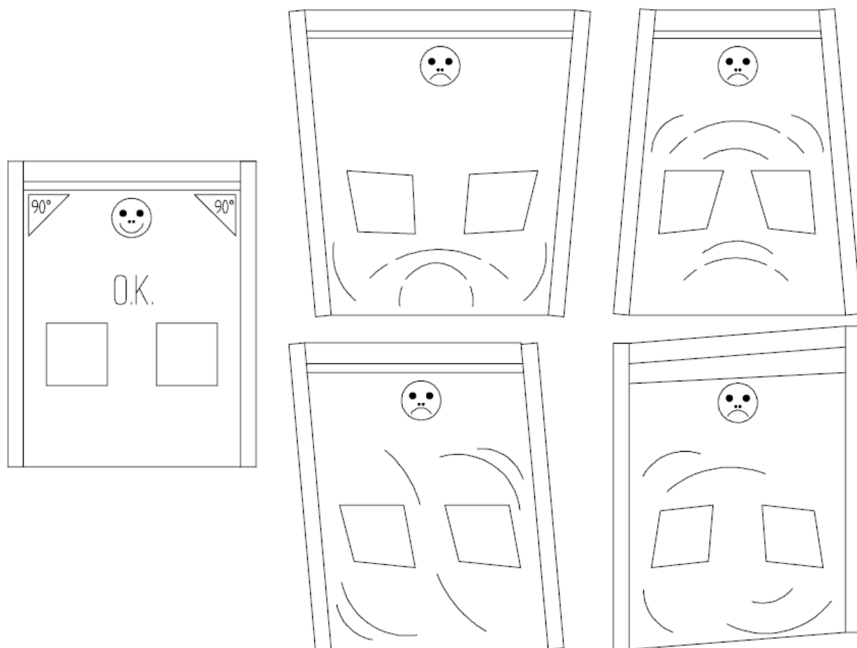
Рисунок 5-7. Установка ворот под правильными углами
